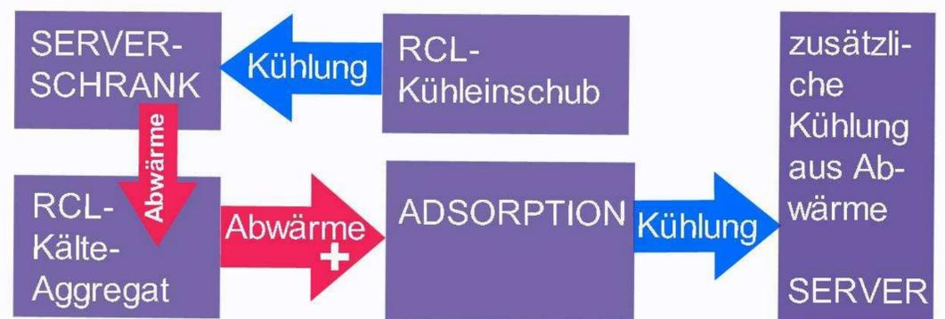
Schema der Abwärmenutzung beim „COOL MUC“
