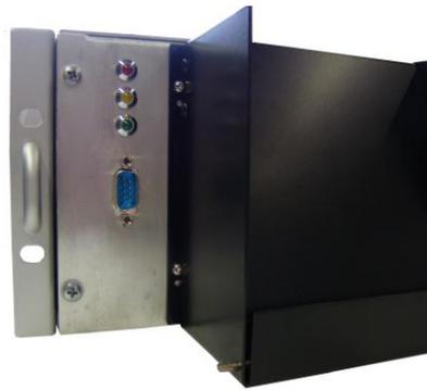
**Front mit Zustandsanzeige und com-Schnittstelle**
