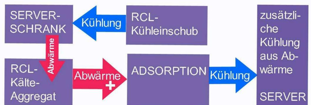
Schema der Abwärmennutzung beim „COOL MUC“
